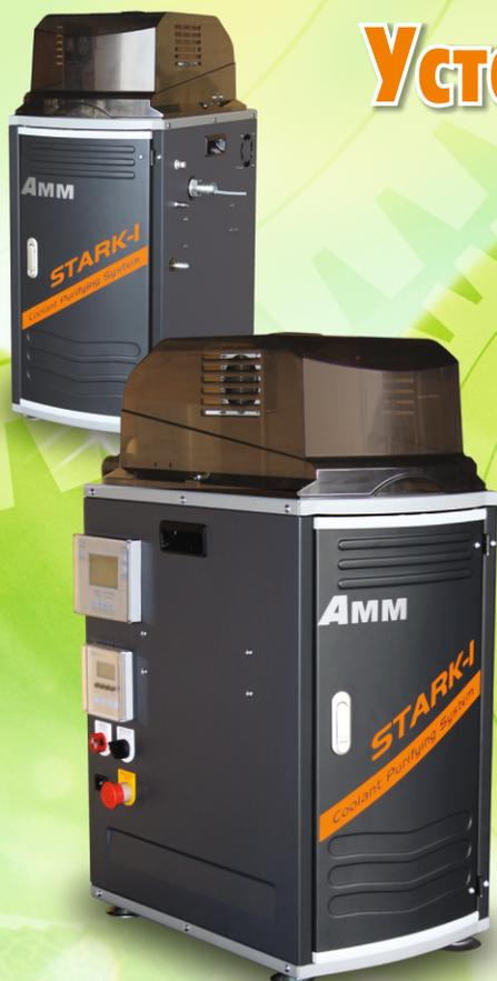
Установка разработана и запатентована компанией Арех. Установка предназначена для работы в составе токарного станка с ЧПУ, фрезерного обрабатывающего центра или в составе любого другого металлообрабатывающего станка, где в процессе обработки используется вододисперсионная СОЖ. Установка позволяет удалять с поверхности СОЖ масло и инородные плавающие частицы, а также препятствует размножению бактерий и микроорганизмов.
